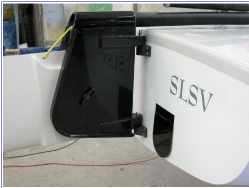
links: fertiges Profilruderblatt im Carbon-Ruderkopf
