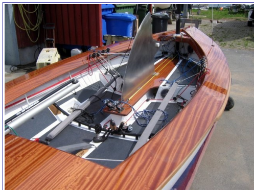
Auch ein Holzdoppelboden, Holzschotten und Holzfurniere auf den sichtbaren Rumpfinnenflächen im Cockpitbereich sind möglich:
