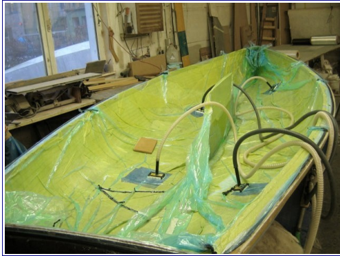
links: Laminieren des GFK-Sandwichrumpfes unter Vakuum
