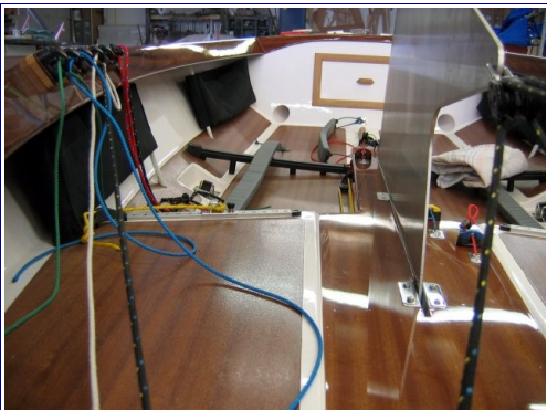
oben und rechts: GFK-Sandwichrumpf mit GFK-Sandwichdoppelboden und Holzdeck
