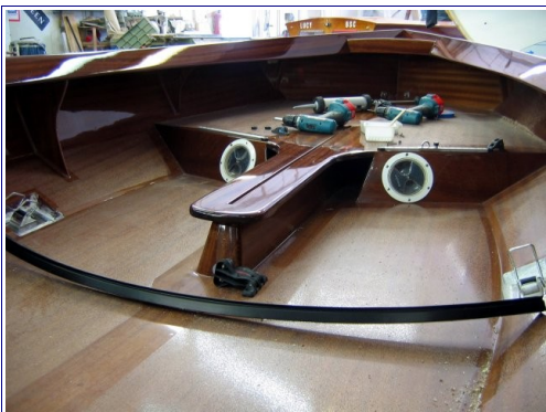
Auch ein Holzdoppelboden, Holzschotten und Holzfurniere auf den sichtbaren Rumpfinnenflächen im Cockpitbereich sind möglich:
